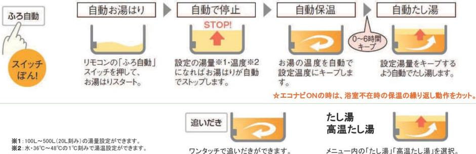
※1: 100L~500L (20L刻み) の湯量設定ができます。 ※2: 水・36℃~48℃の1℃刻みで湯温設定ができます。
